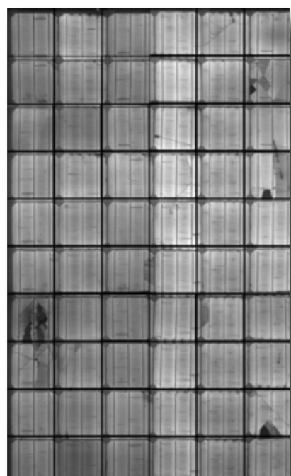
Défauts constatés par test d'électroluminescence uniquement. Essais effectués sur chaque module et non sur échantillon.
